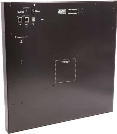
L'AMI26 (ou AMI46) est pré-équipé en face arrière d'inserts M4 pour la fixation d'un pied au standard VESA de 100x100 mm (pied VESA en option).
