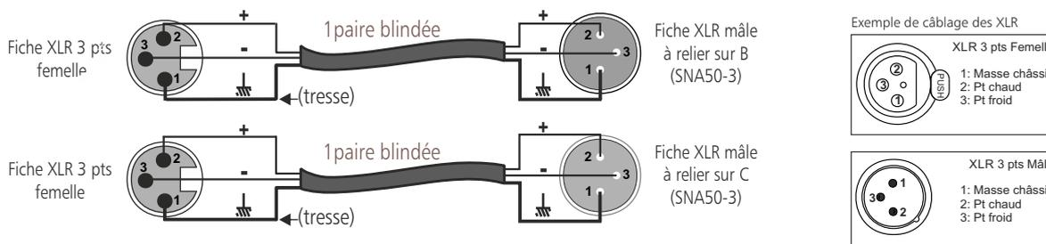
Pour raccorder une table de mixage asymétrique, utilisez un transformateur symétriseur à proximité de celle-ci. Si vous n'avez pas de transformateur symétriseur, alors relier le point froid (-) à la masse ( $\text{mm}$ ) sur l'entrée du SNA.
