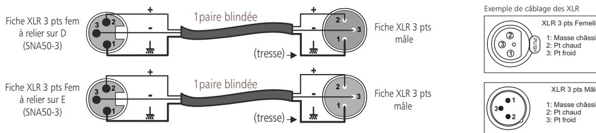
Pour raccorder un amplificateur asymétrique, utilisez un transformateur désymétriseur à proximité de celui-ci. Si vous n'avez pas de transformateur désymétriseur, alors relier le point froid (-) à la masse ( $\text{mm}$ ) sur la sortie du SNA.
