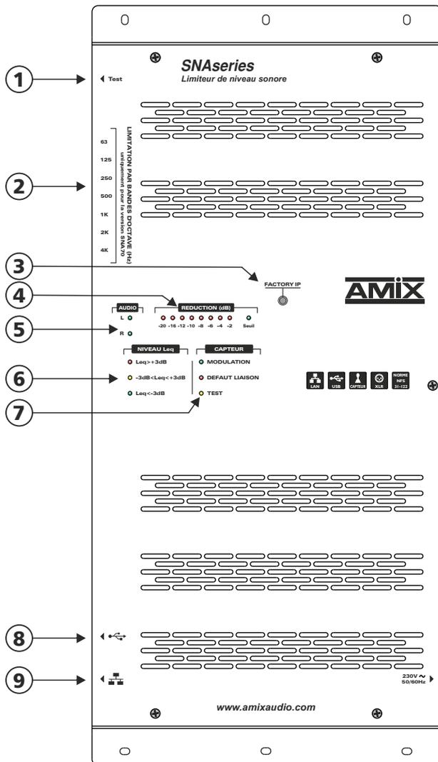
1 - Switch fugitif permettant d'effectuer le test de l'atténuation des VCA. L'appui sur ce switch permet d'atténuer la sortie du limiteur de 40 dB pour vérifier si l'ensemble des signaux audio transite bien par le limiteur.
