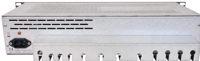
10°) Branchez le SNA50-3 au réseau électrique 230 volts 50Hz, sur l'embase d'alimentation **N**.
