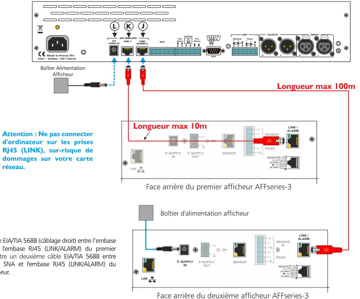
Mettre un câble EIA/TIA 568B (câblage droit) entre l'embase K du SNA et l'embase RJ45 (LINK/ALARM) du premier afficheur. Mettre un deuxième câble EIA/TIA 568B entre l'embase J du SNA et l'embase RJ45 (LINK/ALARM) du deuxième afficheur.
