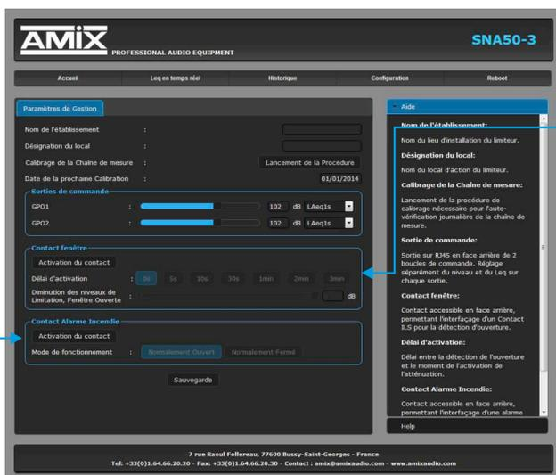
**Contact fenêtre :** En présence de l'ouverture d'une fenêtre ou d'une porte (Si des ILS de contact fenêtre ou porte ont bien été raccordés) le SNA pourra diminuer la valeur de consigne de limitation sonore.
