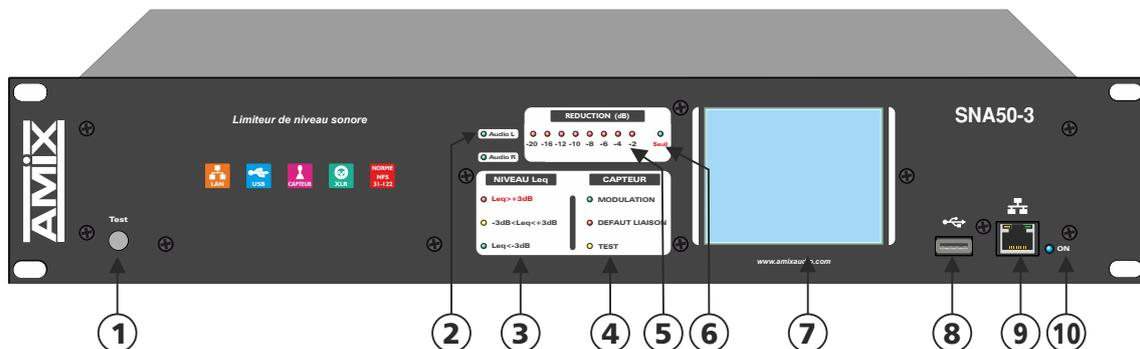
**1 -** Switch fugitif permettant d'effectuer le test de l'atténuation des VCA. L'appui sur ce switch permet d'atténuer la sortie du limiteur de 40 dB pour vérifier si l'ensemble des signaux audio transite bien par le limiteur.
